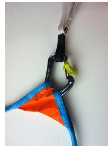
Aucuns autres points d'ancrages sur la sellette. Le harnais n'est pas conçu pour le parapente tracté.
